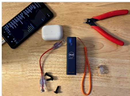
Das Netool-Messgerät richtet sich an Netzwerktechnik- und Administrationsteams und soll als Universalwerkzeug für schnelle Fehleranalysen in kleinen bis mittelgroßen Büro- und Firmennetzwerken dienen.
