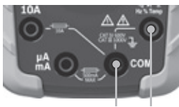
Schwarze Leitung Rote Leitung
